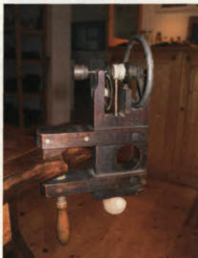
Naprava za izdelavo rezancev, izumitelj Anton Jamnik iz Florjana pri Gornjem Gradu, muzejska zbirka Gornji Grad, 2005.
